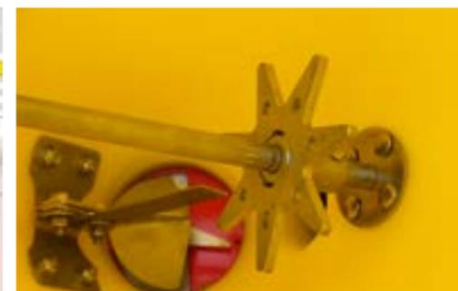
Das von ADLER entwickelte Klopf- und Rührwerk verhindert Brückenbildung beim Streutgut
