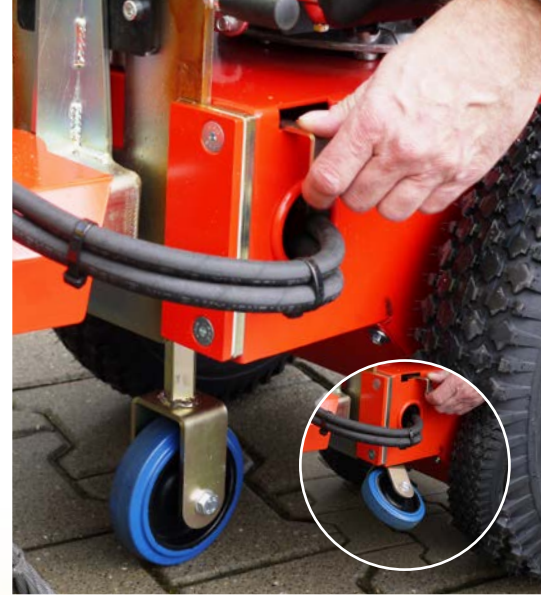
Je nach Einsatzbereich kann das Stützrad bequem ein- oder ausgeklappt werden.
